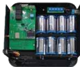
Vista interna sin tapa protectora para baterías.
