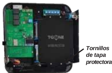
Vista interna con tapa protectora para baterías.
