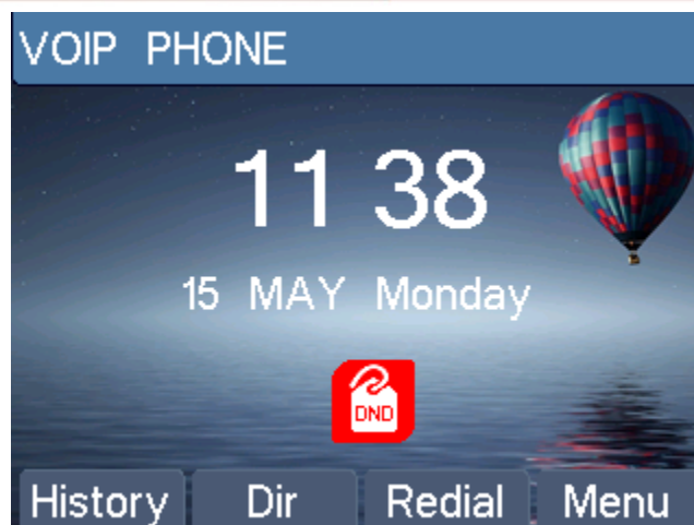
Figura 56 - DND habilitado en todas las líneas
